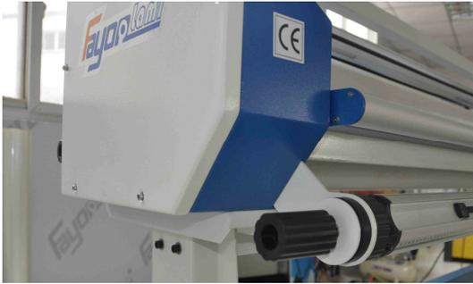
С помощью установленной по обеим сторонам ламинатора рукоятки для натяжения можно регулировать натяжение материала.
