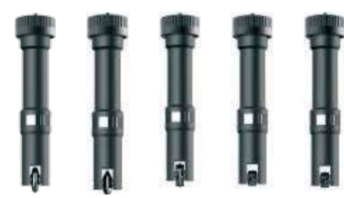
500-9325 ИНСТРУМЕНТ ДЛЯ БИГОВКИ D25 R3 W8 500-9326 ИНСТРУМЕНТ ДЛЯ БИГОВКИ D25 R1.5 W8 500-9327 ИНСТРУМЕНТ ДЛЯ БИГОВКИ D25 R0.75 W1.5 500-9328 ИНСТРУМЕНТ ДЛЯ БИГОВКИ D15 R0.35 W0.7 2PT 500-9329 ИНСТРУМЕНТ ДЛЯ БИГОВКИ D15 R0.17 W0.35 1PT
