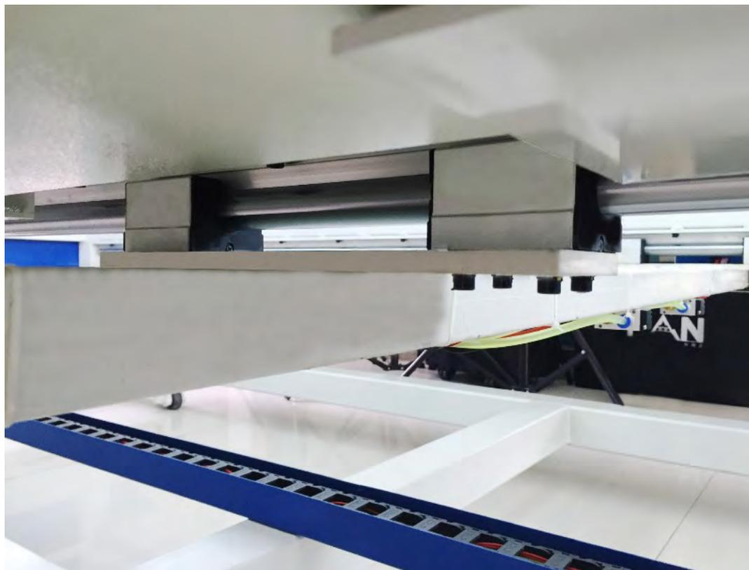
3. Вместо опоры +стальной трубки используется бегунок +направляющая рельса, которая обеспечивает более мощную поддержку при ламинировании, имеет более мягкое движение, обеспечивая более долгий срок эксплуатации.
