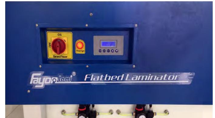
1. Панель управления планшетного ламинатора FAYON имеет главный выключатель питания, световой индикатор питания, светодиодная панель, переключатель холодного/ горячего ламинирования, кнопки настроек. В передней части ламинатора установлено два разделителя-масляный и водный, которые используются чтобы указывать давление воздуха на валы.
