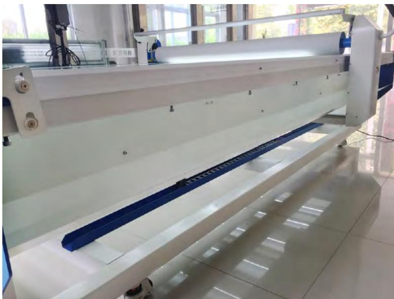
5. Оборудован двусторонними карманами, которые могут использоваться для хранения материала и при ламинировании дорожных знаков очень больших размеров.
