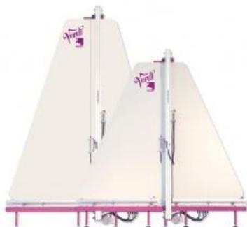
Вертикальные резаки с ручным и электрическим управлением позволяют разрезать различные листовые материалы толщиной до 22 мм и высотой до 3050 мм за считанные секунды такие как MDF, дерево, ПВХ, Dibond, алюминий, метилакрилат, пенокартон, картон и т.д. Пила приводится в движение цепным приводом и возвращается в исходное положение после завершения задания.
