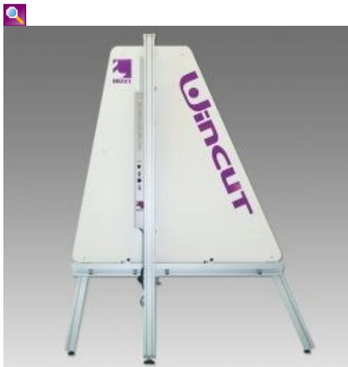
Пневматический резак WINCUT – это вертикальный резак с креплением к стене для резки полужестких материалов и стекла. Максимальная высота реза 2460мм. Этот вертикальный резак с пневматической режущей головкой позволяет разрезать различные листовые материалы толщиной до 20 мм, такие как пенокартон, картон, гофрированный пластик, вспененный ПВХ и стекло толщиной до 3мм.
