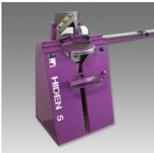
С помощью гильотины **HIDEN MG5** вы получаете ровный и точный разрез, который осуществляется простым нажатием на педаль благодаря специальной системе рычагов. Эта система освобождает руки и позволяет держать руками профиль. Две пружины возвращают режущую головку в исходное положение.
