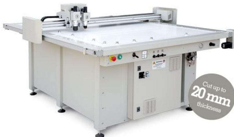
Планшетный режущий плоттер **OPTIMA V** с высокоточным надежным механизмом является идеальным решением для изготовления небольших партий шаблонов, прототипов, выкроек, лекал, упаковок, дисплеев и т.д. Сфера применений данного оборудования многообразна - индустрия офсетной/цифровой печати, рынок изготовления упаковок и дисплеев, а также швейная и обувная промышленность.
