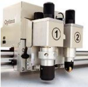
Две независимые головки могут легко регулироваться под разную высоту в зависимости от типа и длины лезвия. Это обеспечивает достижение самого высокого качества и точности резки на разных материалах.
