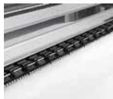
Прижимные ролики могут быть легко отключены индивидуально для предотвращения образования складок и морщин на носителе
