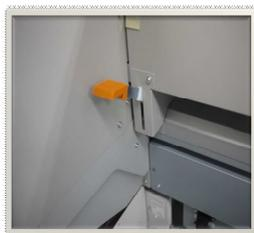
Благодаря **расположенному в задней части принтера рычагу загрузки** носителя облегчается заправка тяжелых и широких носителей.
