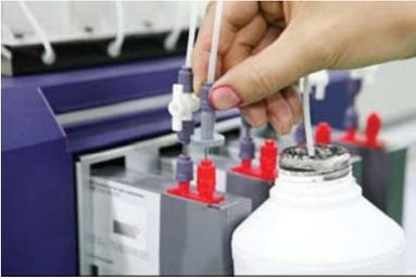
13. После наполнения картриджей чернилами, слегка открутите крышку для удаления воздуха и вставьте трубку для отвода воздуха, затем закрутите крышку.
