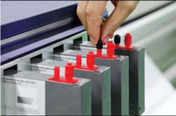
1. Вставьте каждый картридж в соответствующий разъем на принтере, снимите черную крышку.
