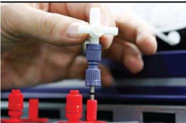
7. Подсоедините Т-образный стопорный клапан с соединителем и уплотнительным кольцом так, чтобы они плотно прилегали друг к другу. Вставьте его до упора и закрепите соединитель.
