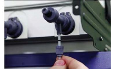
3. (Если необходимо, снимите переднюю крышку). Соедините чернильную трубку с соединителем, а затем с уплотнительным кольцом так, чтобы они плотно прилегали друг к другу. Поместите чернильную трубку на бутылку и воткните до упора, затем плотно закрепите соединитель вручную. (см.п.2-1)
