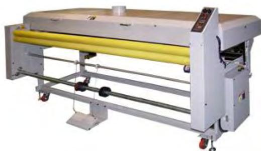
Двусторонняя фиксация обеспечивается протягиванием ткани сквозь инфракрасную камеру с верхним излучателем и нижним отражателем. Устройство оснащено удобным механизмом загрузки ткани. Скорость фиксации до одного погонного метра в минуту позволяет обслуживать не менее трех текстильных плоттеров. Устройство ИК-фиксации TitanJet DTP- 80 отличается увеличенной до двух метров шириной рабочей зоны.
