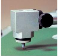
Специальная сменная головка с насадкой для прорисовки декоративных линий вокруг отверстия в паспарту.
