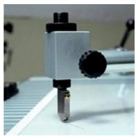
Специальная сменная режущая головка для вырезания стекол овальной и круглой формы.
